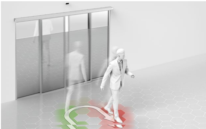
Keskeytynyt avautuminen äkillisen suunnanmuutoksen yhteydessä. Ovi sulkeutuu ennen kuin se on täysin auki.
