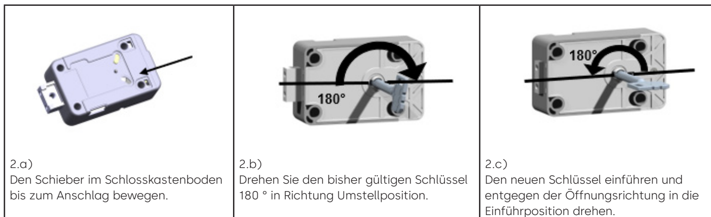
Bild 2: Umstellvorgang am Beispiel "Riegel links"
