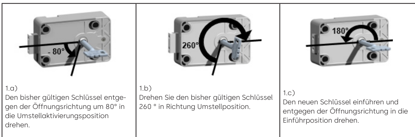
Bild 1: Umstellvorgang am Beispiel "Riegel links"
