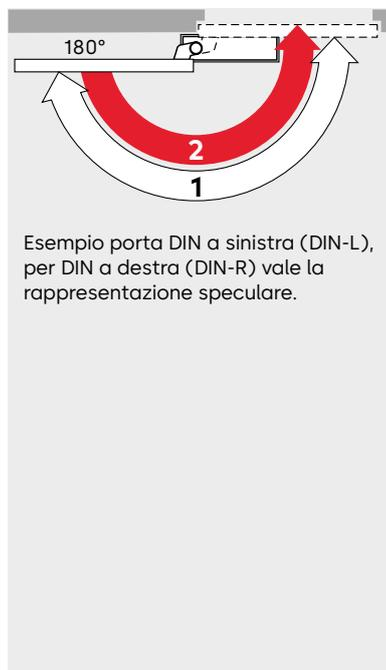
Esempio porta DIN a sinistra (DIN-L), per DIN a destra (DIN-R) vale la rappresentazione speculare.
