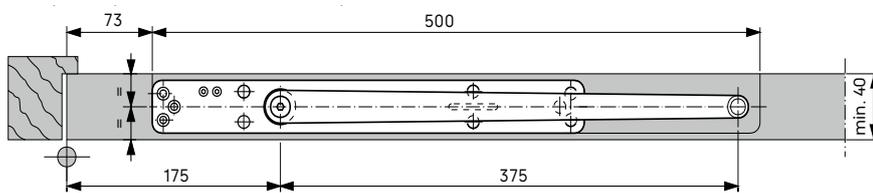
ITS Home ha le stesse dimensioni del chiudiporta ITS 96 EN 2-4. Il sistema di ammortizzazione è compatibile con le guide di scorrimento G 96 N e G 96 N 20. Gli accessori corrispondenti sono anch'essi compatibili. Ulteriori informazioni sul sistema ITS 96 e i disegni di montaggio sono disponibili nella brochure dedicata al sistema ITS 96.
