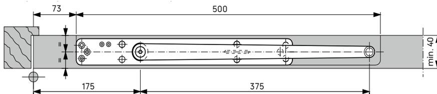
L'ITS Home a les mêmes dimensions que le ferme-porte ITS 96 EN 2-4. Il peut être utilisé avec les rails de guidage G 96 N et G 96 N 20. Les accessoires correspondants sont compatibles. Vous trouverez de plus amples informations sur le système ITS 96 et les schémas de montage dans la brochure du système ITS 96.
