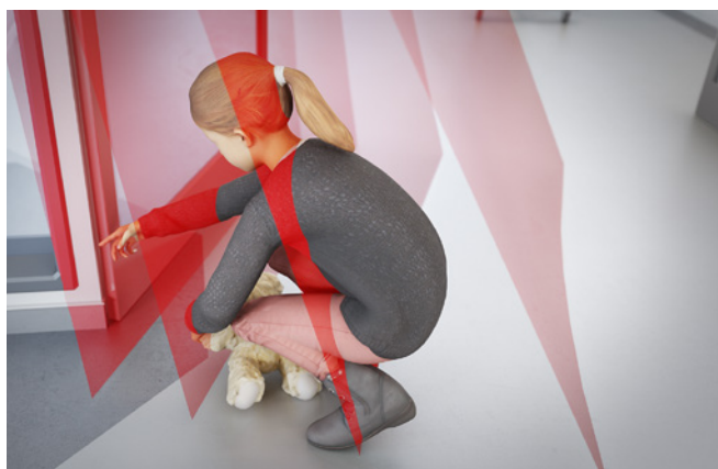
Het draaigebied is beveiligd. De knelzone telt 100 meetpunten, verdeeld over 18°. Deze optimaliseren de detectie van handen en vingers in het draaigebied en de scharnierzones.
