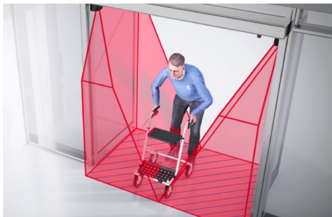
De volledige deurzone wordt beveiligd. De deuren sluiten enkel wanneer de doorgangszon vrij is.
