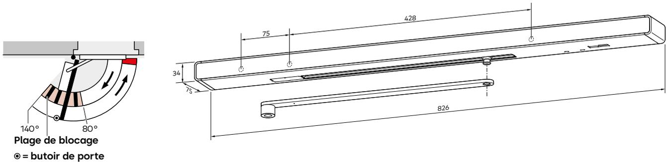
L'installation en design XEA peut être montée sur les portes à 1 vantail avec une largeur de vantail jusqu'à 1 250 mm. L'alimentation électrique par batterie offre une grande flexibilité dans la planification, aucune alimentation externe n'étant nécessaire. Le G-Ubivis XEA donc idéal pour les mises à niveau d'équipements existants dans les bâtiments qui ne permettent pas d'interventions dans la structure, par exemple les monuments historiques protégés.
