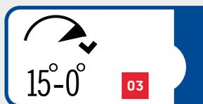
**03** SoftFlow : une zone de fermeture réglable de 15° à 0° permet un amortissement de fin de course de la porte.
