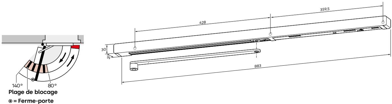
La glissière G-EMR XEA permet d'équiper les portes résistantes au feu et pare-fumée de manière à pouvoir les bloquer avec précision et les surveiller et les commander indépendamment des autres systèmes. Le point de blocage est réglable à un angle d'ouverture compris entre 80° et 140°. Pour prévenir tout endommagement de la porte ou du ferme-porte, un butoir de porte doit être installé.
