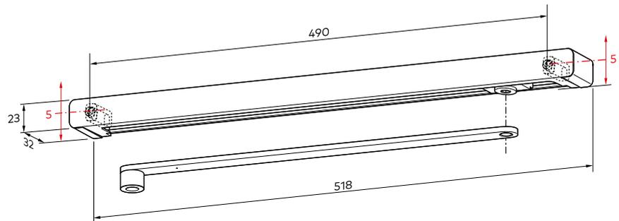
La glissière G-N XEA comprend bras, coulisseau, pièces de fixation, vis et embouts. La glissière G-N XEA est utilisable pour les portes DIN Gauche comme DIN Droite et peut être combinée avec tous les modèles de ferme-portes en design XEA.
