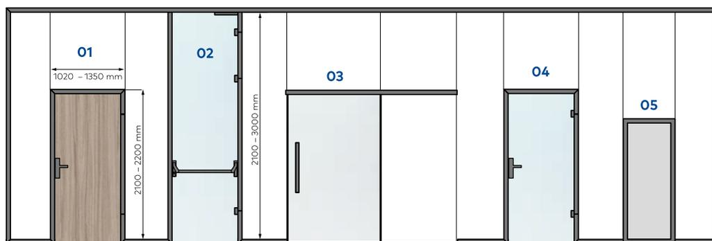
**01 Porta basculante** (2 dobradiças) com elemento de madeira e encaixe (integração com sistema de controle de acesso - opcional).
