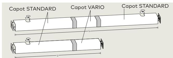
Capot en aluminium permettant le capotage continu de deux mécanisme de portes vantaux sur porte à deux vantaux. Deux capot STANDARD sont nécessaires et sont disposés à droite et à gauche sur les mécanisme.
