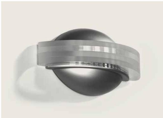
Lumière de signalisation rouge-vert donne l'état de l'automatisme de porte. Le témoin de signalisation en acrylique, en forme de croissant bien visible, est équipé d'indicateurs DEL à grande clarté (24 V, luminosité conformément à DIN VDE 0834, 1e partie). Les signaux lumineux sont visibles sur les deux faces à une grande distance et sur la face frontale.
