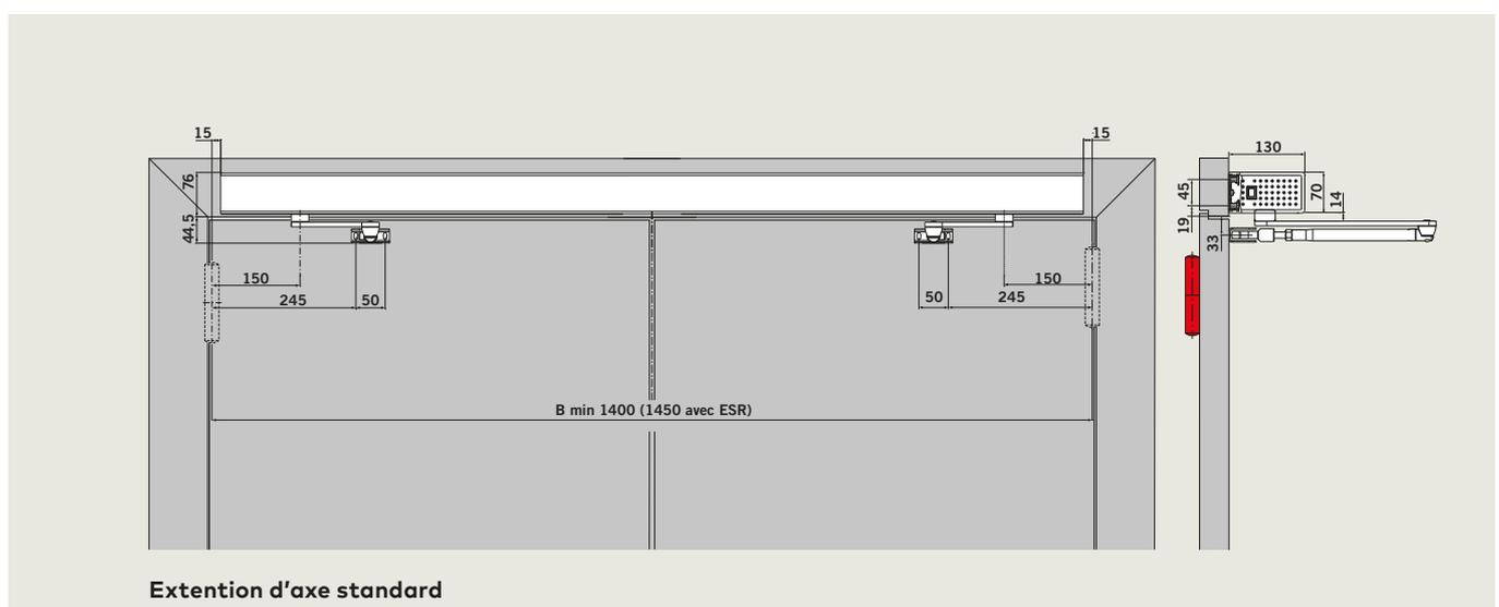
**Gabarit de perçage : Capot Vario, montage tirant, coulisseau 12,5 mm**
