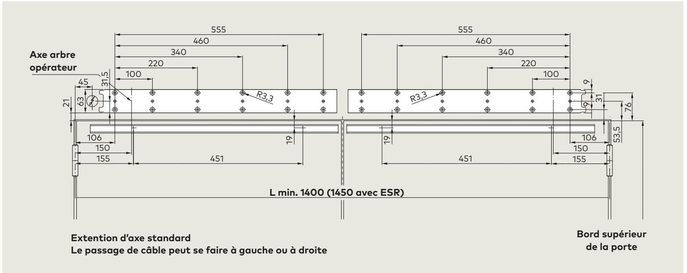
**Gabarit de perçage : Capot Vario, montage tirant, coulisseau de glissière 25 mm**
