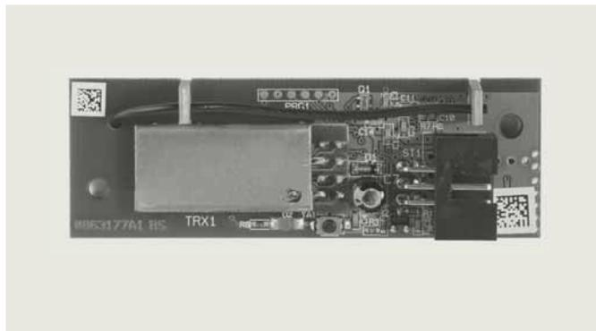
Le nouveau récepteur radio BRC-R peut être aisément installé dans le mécanisme à l'aide d'un emplacement prévu et fixé avec deux vis sur l'unité moteur-transmission. Trois types d'émetteur différents sont disponibles.
