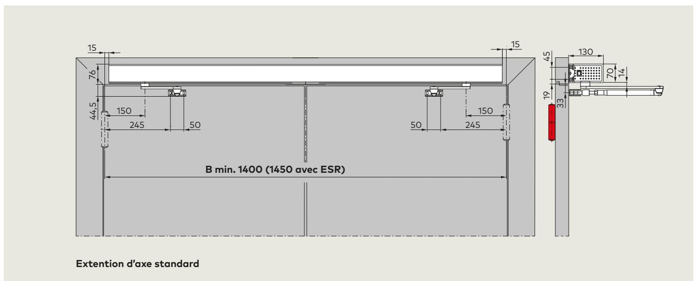
**Gabarit de perçage : Capot Vario, montage tirant, montage axe coulisseau 12,5 mm**
