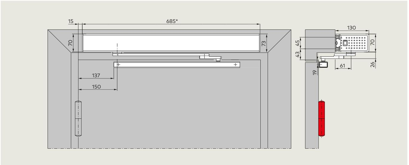
**Capot standard, tirant, bras CPD, axe coulisseau 25 mm, extension d'axe standard**
