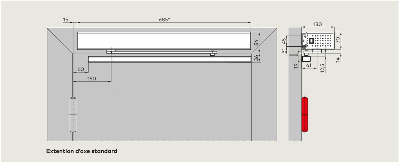
**Capot standard, montage tirant, montage avec axe du coulisseau de glissière 25 mm**
