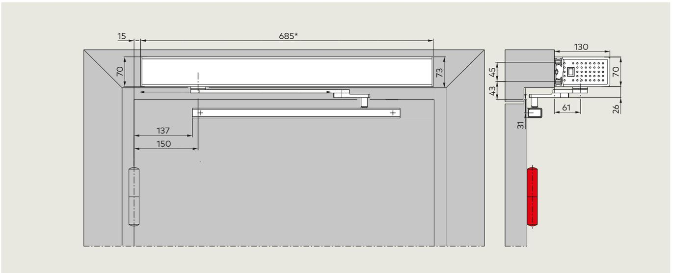
\*dimension capot RM avec détecteur de fumée intégré: 735 mm
