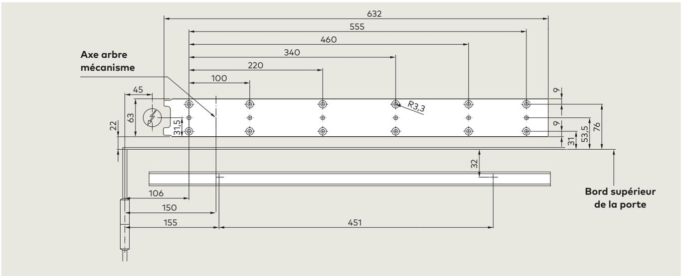
**Capot standard, montage tirant, levier CPD, axe coulisseau 12,5 mm, extension d'axe standard**
