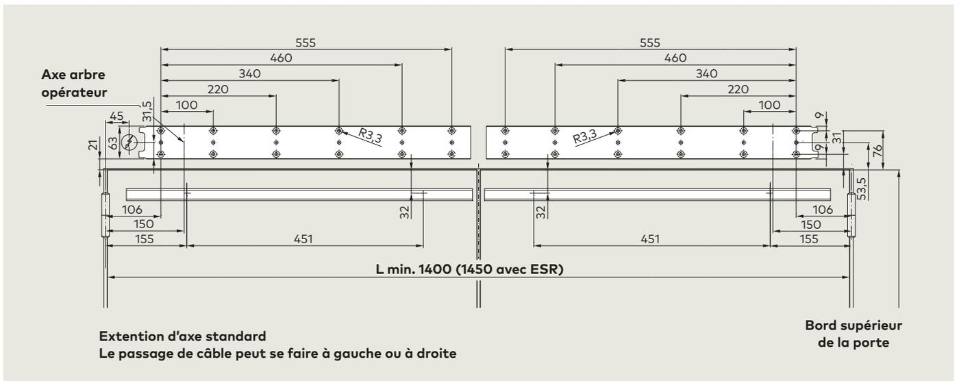
**Gabarit de perçage : Capot Vario, montage poussant**
