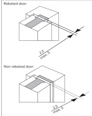
Fig. 32 Check the door gap
