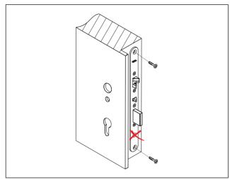
Fig. 24 Screw door lock tight
