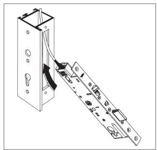
Fig. 16 Insert door lock
