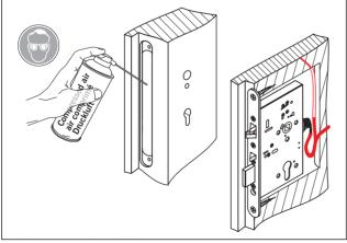
Fig. 23 Insert door lock
