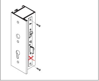
Fig. 17 Screw door lock tight
