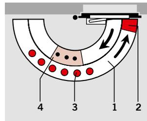
Die **Schließgeschwindigkeit** des TS 91 ist über Ventile in zwei voneinander unabhängigen Bereichen stufenlos einstellbar. Die **Schließkraft** ist beim TS 91 fest auf Größe EN 3 eingestellt.
