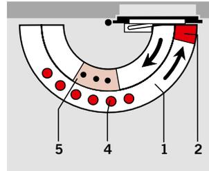
Die **Schließgeschwindigkeit** des TS 92 ist über Ventile in zwei voneinander unabhängigen Bereichen stufenlos einstellbar. Die **Schließkrafteinstellung** für die jeweilige Türbreite erfolgt beim TS 92 stufenlos über die seitliche Stellschraube.
