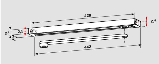
Die Gleitschiene **G-N** umfasst Hebel, Gleitschiene, Gleitstück, Befestigungsstücke, Schrauben und Endkappen. Die Gleitschiene G-N ist sowohl für DIN-L- als auch für DIN-R-Türen verwendbar und kann mit beiden Türschließern kombiniert werden.
