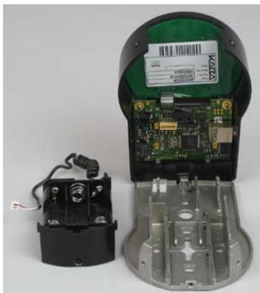
4. Fije la placa base a la puerta con los tornillos especiales adjuntos de cabeza plana M4x12. La unidad de entrada debe fijarse a la puerta con al menos dos tornillos ubicados uno frente a otro. Se recomienda el tercer tornillo (pos. 1).
