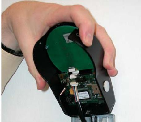
10. Pliegue lentamente la cubierta hacia la placa base mientras empuja con cuidado el cable de conexión hacia la cámara de la cerradura; deje algún espacio libre.
