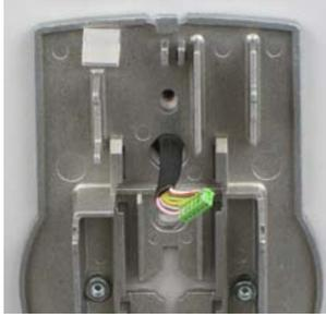
6. Monte en el lugar adecuado el compartimento de las pilas. A continuación, tienda con cuidado el cable de la batería a través de las guías pasacables del compartimento de las pilas y de la placa base. **Asegúrese de que el cable no quede aplastado.**
