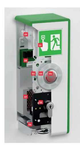
Il terminale di porte STL-G è composto dai componenti tasto di emergenza e interruttore chiave in un alloggiamento a vista. In collegamento con un sistema di bloccaggio elettrico, il terminale di porte STL-G soddisfa i requisiti della UNI EN 13637 ovvero della EltVTR.
