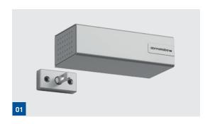
Bloccaggio porta elettromeccanico (principio di corrente di riposo) da fissare sul bordo del telaio. Collegamento alla SCU esclusivamente tramite bus DCW® a 4 fili. Il blocco porta STV 1xx si apre senza incepparsi e senza ritardi. La forza di tenuta massima è conforme alle norme EltVTR ed EN 13637 classe 3.
