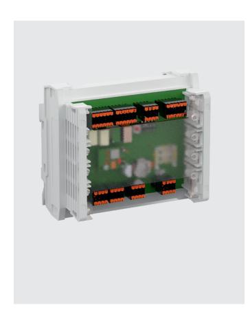
La SCU-DR viene utilizzata con una scheda con licenza come centrale di controllo e monitoraggio (Master). Per l'allestimento di un sistema di protezione delle vie di fuga secondo UNI EN 13637 o EltVTR sono necessari almeno un tasto di emergenza ed un pulsante a chiave (ad es. il set di fornitura doppio SCU-UP oppure io terminale a vista STL-G), così come il bloccaggio della porta STV. Il montaggio avviene su una guida a tuba DIN oppure nell'alloggiamento NT G1/NT G2.
