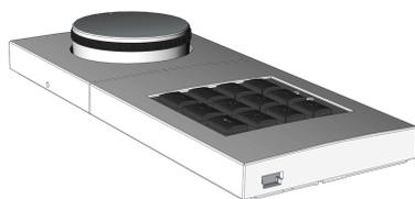
1. Den Mini-USB-Stecker des CB 90 Adapterkabels in die Mini-USB-Buchse an der Seite der Eingabeeinheit stecken.
