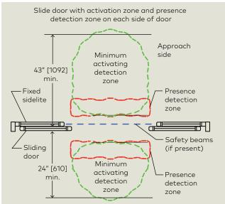
Fig. 5.1.3 Single slide door floor mat layout
