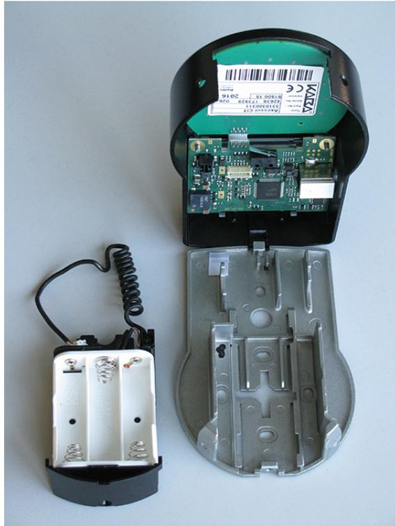
8. Die 3 Schrauben unten an der Abdeckung (1 am Batteriefach, 2 am Gehäuse) entfernen.
