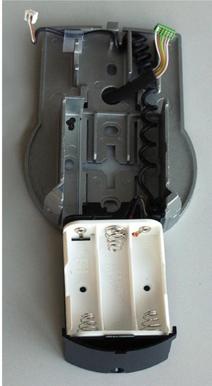
3. Abdeckung in einem Winkel von  $>90^\circ$  an der Grundplatte positionieren.
