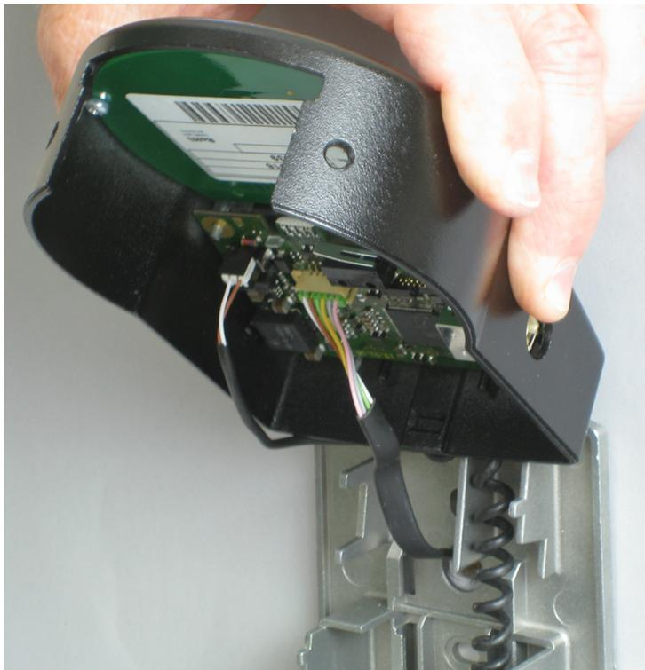
4. Batteriekabel in die 2-polige, Anschlusskabel in die 6-polige Anschlussklemme einstecken.
