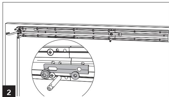
Auf den äußeren Rillen der Montageplattenverlängerung je 2 Löcher mit  $\varnothing 5,5$  mm bohren.
