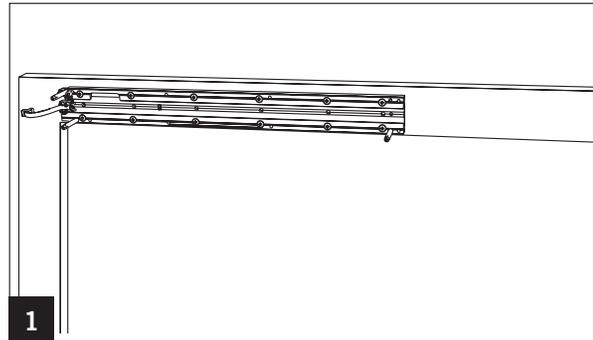
Montageplattenverlängerung an die Montageplatte halten und mit dem beiliegenden Verbinder und zwei Schrauben befestigen.
