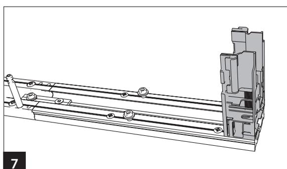
Den mittleren Halter unter die mittleren Schrauben schieben und fest anschrauben.
