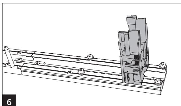
Den Halter unter die Schrauben schieben und die Schrauben fest anziehen.
