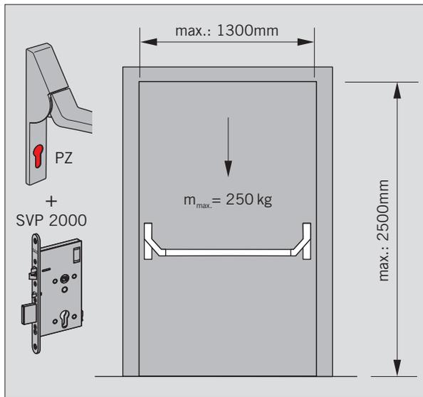
Der Panik-Beschlag kann bei extremen Türsituationen mit einer Türbreite  $X < 1000$  mm in Verbindung mit dem Abstand des Bandes  $Y > 90$  mm evtl. nicht nach den Standardmaßen montiert werden. Einbauvorschläge stellt dormakaba Ihnen auf Anfrage zur Verfügung.
