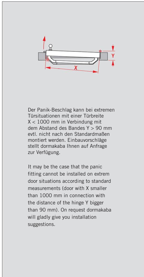
Der Panik-Beschlag kann bei extremen Türsituationen mit einer Türbreite  $X < 1000$  mm in Verbindung mit dem Abstand des Bandes  $Y > 90$  mm evtl. nicht nach den Standardmaßen montiert werden. Einbauvorschläge stellt dormakaba Ihnen auf Anfrage zur Verfügung.
