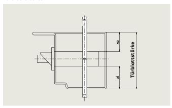
Die im Lieferumfang des PHA 2500 Systems enthaltenen Drückerstifte sind für eine Türblattstärke von 46–76 mm geeignet.
