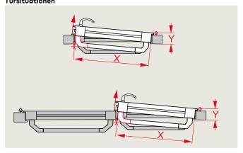
Der Panik-Beschlag kann bei extremen Türsituationen mit einer Türbreite X < 1000 mm in Verbindung mit dem Abstand des Bandes Y > 90 mm evtl. nicht nach den Standardmaßen montiert werden.
