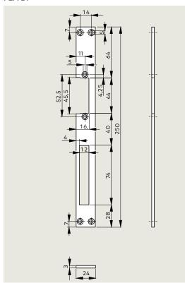
Flachschließblech aus Edelstahl, DIN-R und DIN-L verwendbar, zur Kombination mit den Türöffnern der Serie Smoke und Fire 447 Bestell-Nr. 15180224
