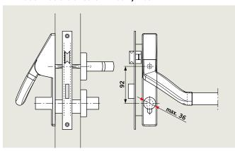
Einsatz eines elektronischen Knopfzylinders gemäß Konformitätszertifikat 0432-BPR-0066 dormakaba PHA 2500.
