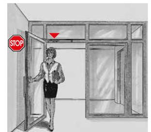
Die Rastfeststelleinheit ermöglicht ein exaktes Feststellen von Türen ohne Rückfederung bis zu einem Öffnungswinkel von ca. 120°.
