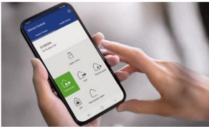
Die Antriebe der ES PROLINE Reihe können optional mit dem Door Pilot Interface ausgestattet werden. Über die Door Pilot App lassen sich verschiedene Zustandsmeldungen des Antriebs leicht per Smartphone auslesen und Funktionen steuern. Ein weiterer Service-Vorteil des neuen Antriebssystems.
