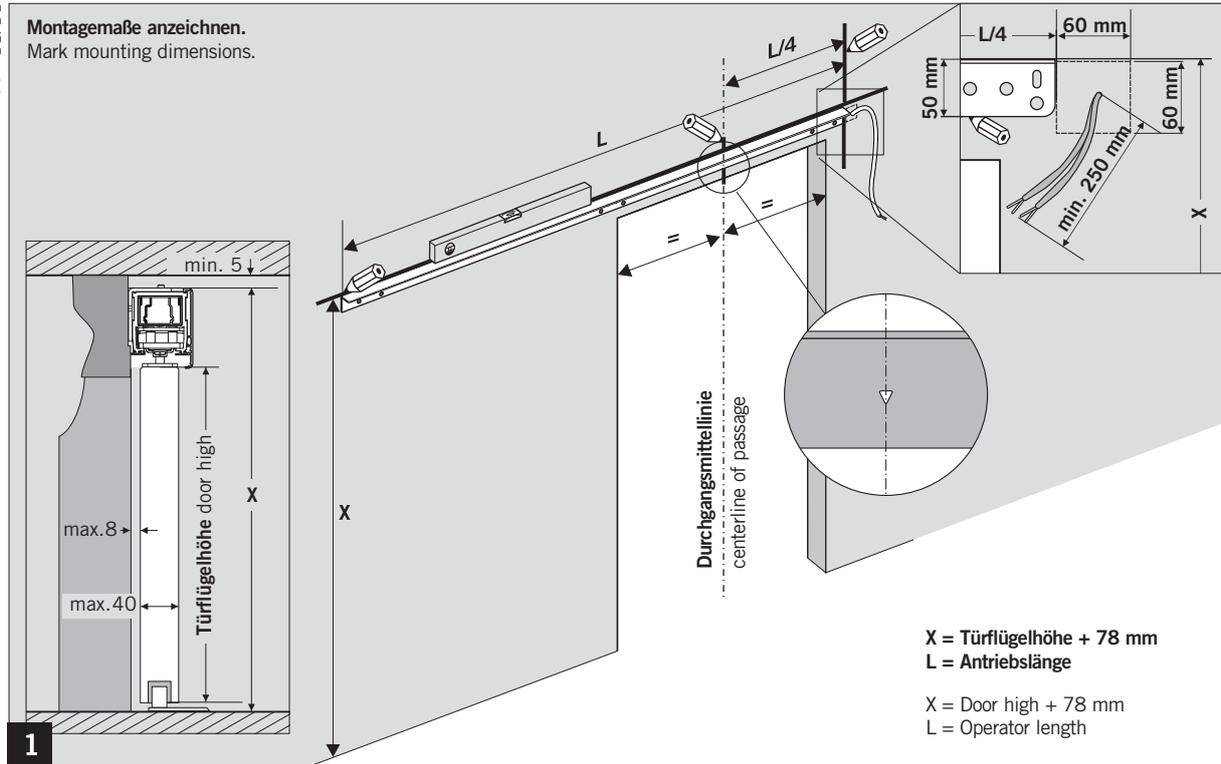
**Montagewinkel an Wand befestigen.** Gleichen Sie eventuelle Unebenheiten der Wand mit Ausgleichblechen aus.
