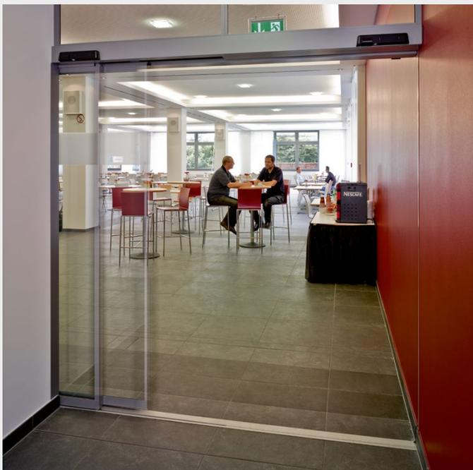
Die Teleskop-Schiebetür TST FLEX basiert auf dem gleichen Profilsystem wie die ST FLEX Schiebetüren. Die geringen Profilansichtsbreiten lassen die Tür insgesamt sehr transparent erscheinen. Weitere Türtypen aus der FLEX-Familie lassen sich in einem Gebäude sehr harmonisch kombinieren. Die Verglasung der Türflügel erfolgt durch Isolierglas ISO 22 mm.
