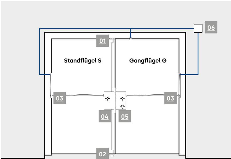
**01** Stangenschliessblech für Türzarge und Schaltschloss für obere Treibriegelstange
