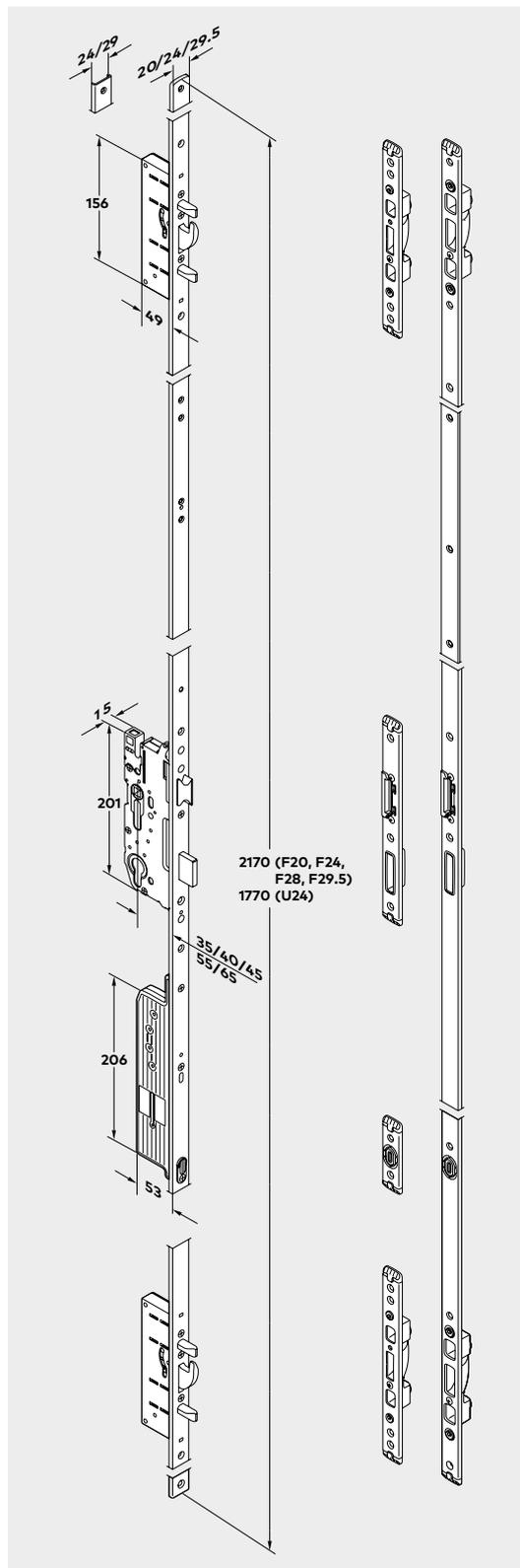
Motorische Entriegelung (Kurzzeit- und Dauerentriegelung sowie Tagesfallenfunktion) über Zutrittskontrollsysteme, Wechselfunktion zur Entriegelung per Schlüssel von aussen. Die integrierte Panikfunktion ermöglicht jederzeit eine Öffnung in Fluchrichtung durch einfache Betätigung des Türdrückers. Zertifiziert nach EN 179 und EN 1125 zum Einsatz mit Paniktürbeschlägen.
