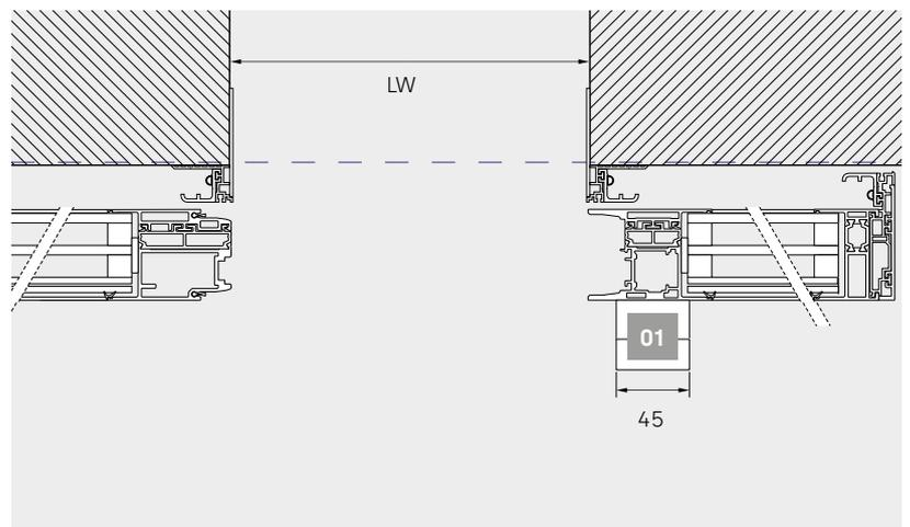
Se la porta scorrevole è dotata di uno sblocco manuale e di un'anta di protezione, la larghezza del passaggio libera LW si riduce di 83 mm per i sistemi a 1 anta e a 166 mm per quelli a 2 ante.
