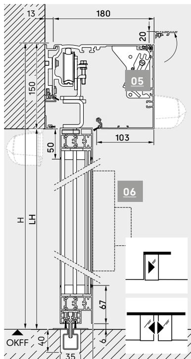
**Varianti di montaggio e coperture per azionamenti**
