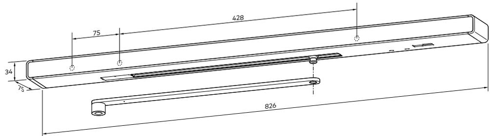
**Il dispositivo in design XEA può essere montato su porte ad un'anta con una larghezza fino a 1.250 mm. Alimentato a batteria consente alta flessibilità nel processo di progettazione in quanto non è necessario un collegamento elettrico esterno. In questo modo il G-Ubivis XEA è particolarmente un'installazione successiva in edifici che non consentono interventi nella struttura e soggetti alla protezione dei beni culturali.**
