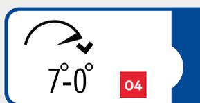
**O4** Finecorsa regolabile nell'intervallo di chiusura di 7°-0°.
