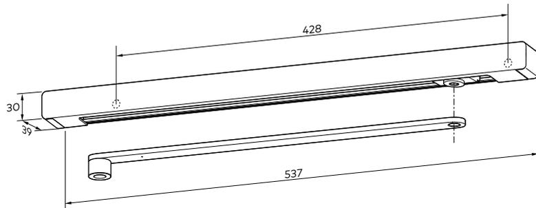
La G-EMF XEA consente un bloccaggio esatto della porta senza molla di ritorno. Il punto di bloccaggio può essere regolato ad un angolo di apertura tra circa 80° e 140°. Il punto di bloccaggio è contemporaneamente l'angolo di apertura porta. Per evitare danni alla porta e al chiudiporta deve essere usato un fermaporta.
