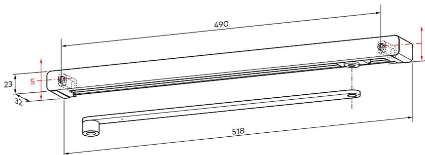
La G-N XEA comprende leva, guida di scorrimento, pattino scorrevole, pezzi di fissaggio, viti e tappi terminali. La guida di scorrimento G-N XEA può essere usata sia per porte DIN sinistre che per porte DIN destre e può essere combinata in tutte le esecuzioni del chiudiporta in design XEA.
