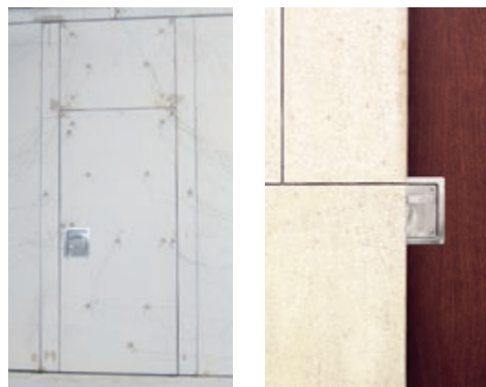
Laboratoryjną próbę klasy ognioodporności ścianki działowej Variflex EI 30 z zamontowanymi drzwiami przejściowymi przeprowadzono poddając ją bezpośredniemu działaniu ognia przez ponad 30 minut.
