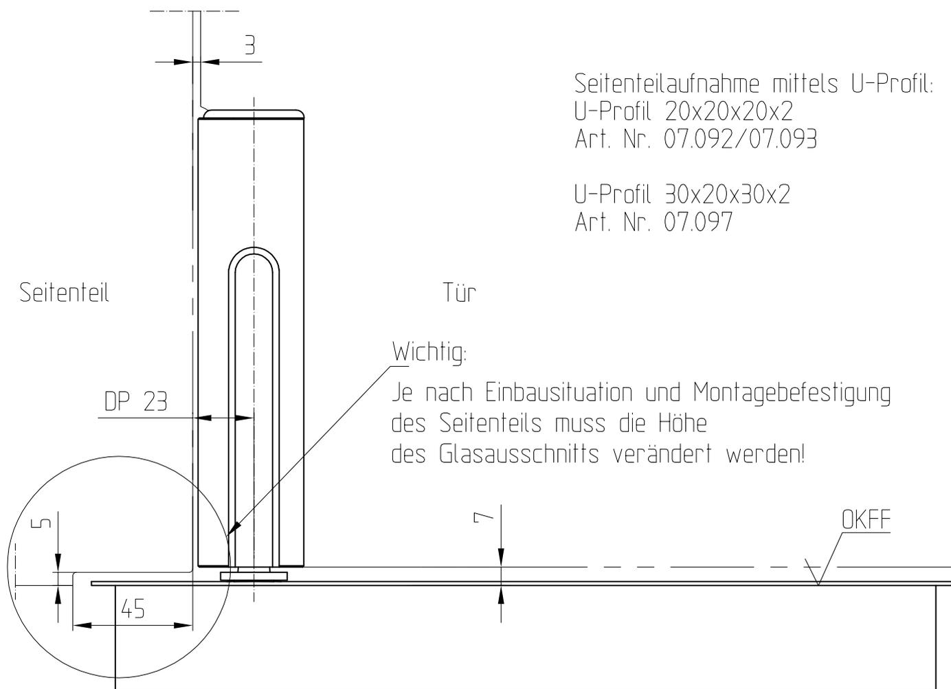
Seitenteilaufnahme mittels U-Profil:
