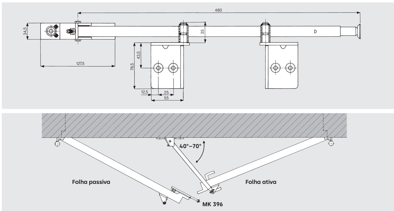
O SR 390 é um seletor de fecho comprovado, puramente mecânico, para portas cortafogo e cortafumo de folha dupla. É montado no aro da porta e pode ser utilizado à esquerda e à direita. O SR 390 garante um fecho uniforme das folhas da porta
