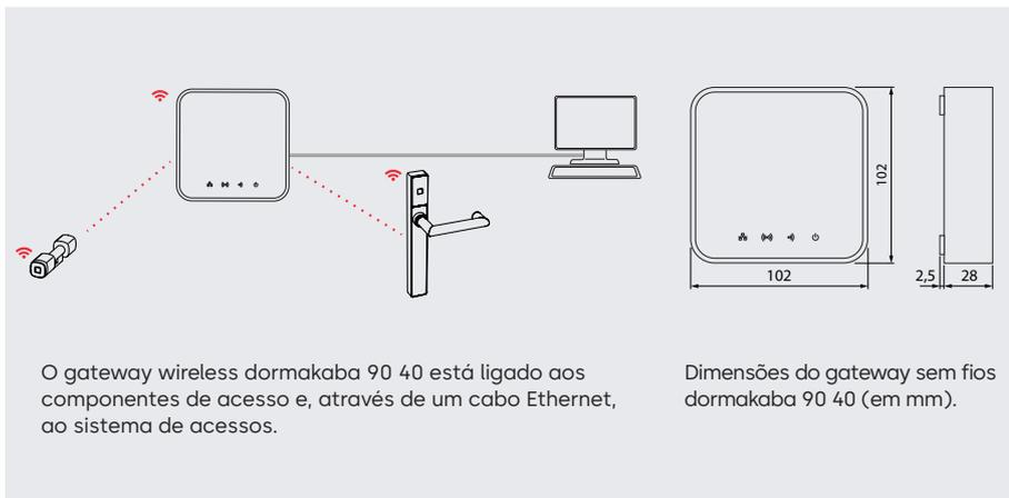
O gateway wireless dormakaba 90 40 está ligado aos componentes de acesso e, através de um cabo Ethernet, ao sistema de acessos.
