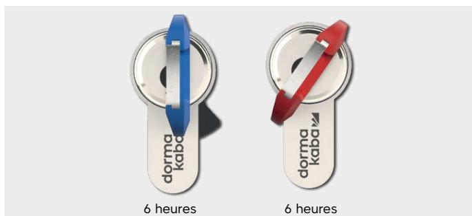
**Besoin d'un accès temporaire pour le personnel de service ? Un tour de clé suffit !** Il y a une clé propriétaire et une clé de service. Si la clé propriétaire – par ex. du propriétaire de la maison – est retirée du cylindre de fermeture SAT en position 8 heures, la porte peut également être ouverte avec la clé de modification de service. Si l'on retire la clé propriétaire en position 6 heures, la porte ne peut pas être ouverte de l'extérieur avec la clé de service
