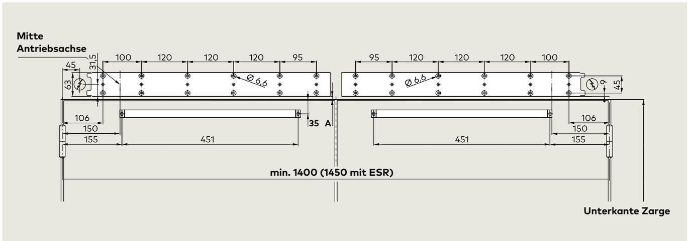
**Bohrbild: Hebelbolzen lang 25 mm**
