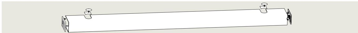
Aluminiumverkleidung zum Aufbau von zweiflügeligen Drehtüranlagen. Die ED Verkleidung PROFESSIONELL ist eine durchgängige, nahtlose Verkleidung. Sie kann in Längen von 1.400 mm (1.450 mm mit ESR) bis 3.200 mm geliefert werden. Mit der Verkleidung PROFESSIONELL können auch einflügelige Antriebe in Richtung der Hauptschliesskante bis zu einer Gesamtlänge von 3.000 mm verlängert ausgeführt werden.
