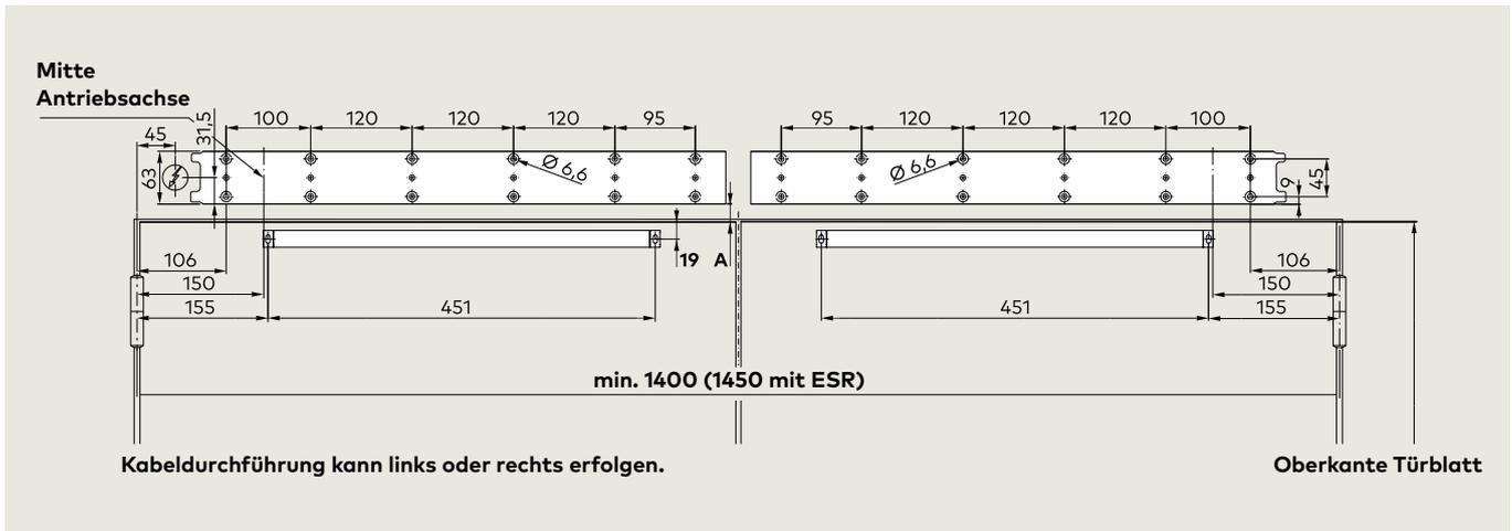
Bohrbild: Hebelbolzen lang 25 mm
