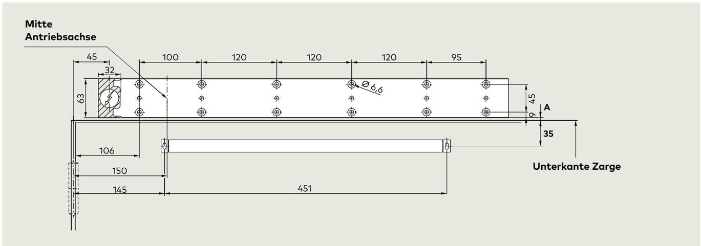
**Bohrbild: Hebelbolzen lang 25 mm**
