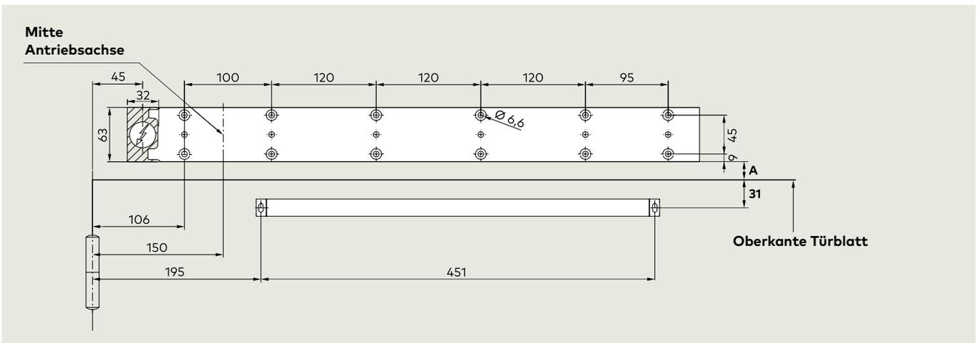
Bohrbild: Hebelbolzen lang 25 mm
