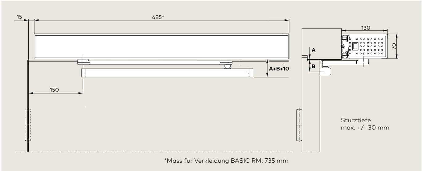
**Bohrbild: Hebelbolzen kurz 12,5 mm**
