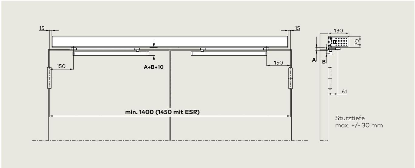
Bohrbild: Hebelbolzen kurz 12,5 mm
