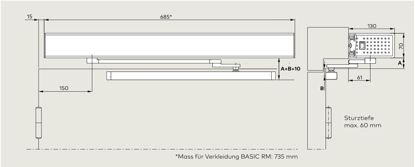
Bohrbild: Hebelbolzen kurz 12,5 mm
