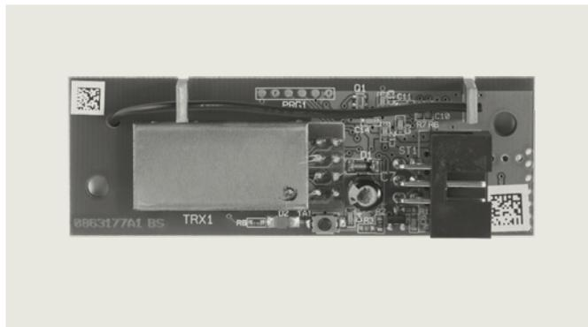
Der Funkempfänger BRC-R kann leicht in den Antrieb eingebaut werden. Der Empfänger ist auf die Abmessungen angepasst und wird mit zwei Schrauben auf der Motor-Getriebe-Einheit befestigt. Als Sender stehen drei verschiedene Typen zur Verfügung. Es können bis zu 1024 Sender in einem BRC-R gespeichert werden.
