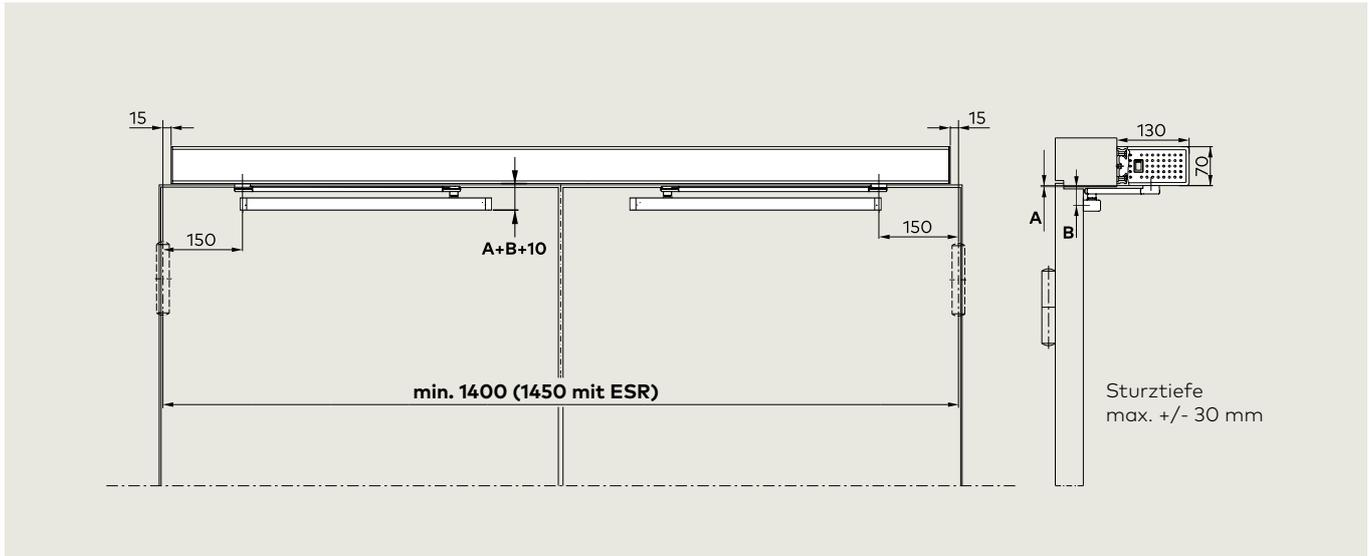
**Bohrbild: Hebelbolzen kurz 12,5 mm**
