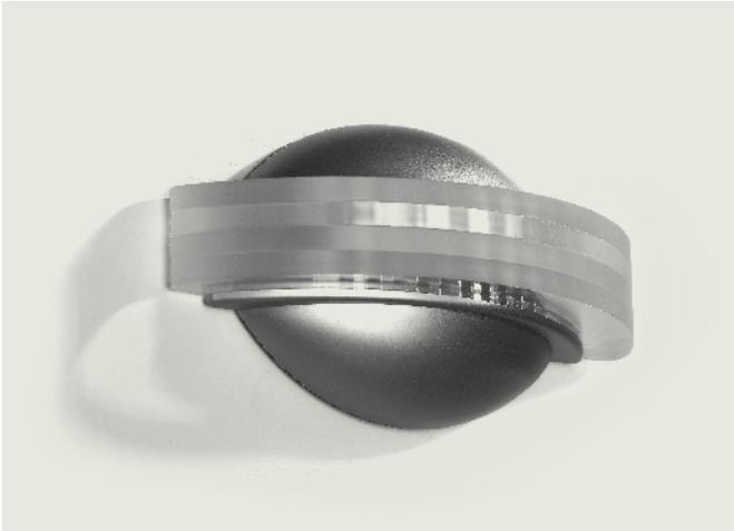
Das Rot-Grün-Display zeigt den Status der Türanlage an. Die extravagante, halbrunde Acryl-Design-Signalleuchte mit moderner LED-Technologie verfügt über Highgrade-LED-Anzeigen (24 V, Leuchtkraft gemäss DIN VDE 0834, Teil 1). Die Lichtsignale sind auch aus grosser Entfernung beidseitig und frontal erkennbar. Lichtsignal, 24 V DC, LED-Anzeige rot, grün, weiss
