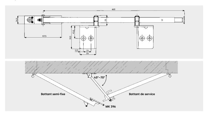
Le SR 390 est un régulateur de séquence de fermeture éprouvé, à fonctionnement purement mécanique pour les portes coupefeu et pare-fumée à 2 battants.
