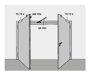
Exemple d'installation pour le régulateur de séquence de fermeture SR 390
