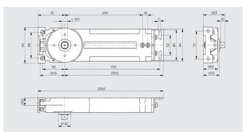
\* Angolo di apertura porta, entrambi i lati max. 130°; per le porte pesanti che possono essere aperte ulteriormente, assicurarsi di impostare i fermaporta. Con le porte a battuta, l'angolo di apertura della porta può essere ridotto a seconda della costruzione della porta.
