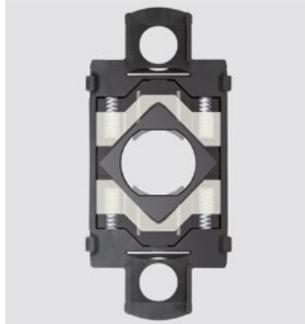
Die Technik der Beschlagserie OGRO ist für die hohen Belastungen im Objekt ausgelegt. Vier Hochhaltefedern sorgen dafür, dass die Türdrücker auch im intensiven Dauergebrauch in waagerechter Position bleiben. So ist eine dauerhafte Stabilität der Garnituren auch bei hohen mechanischen Ansprüchen sichergestellt. Die durchdachte Technik sorgt zudem für einen hohen Begehkomfort.
