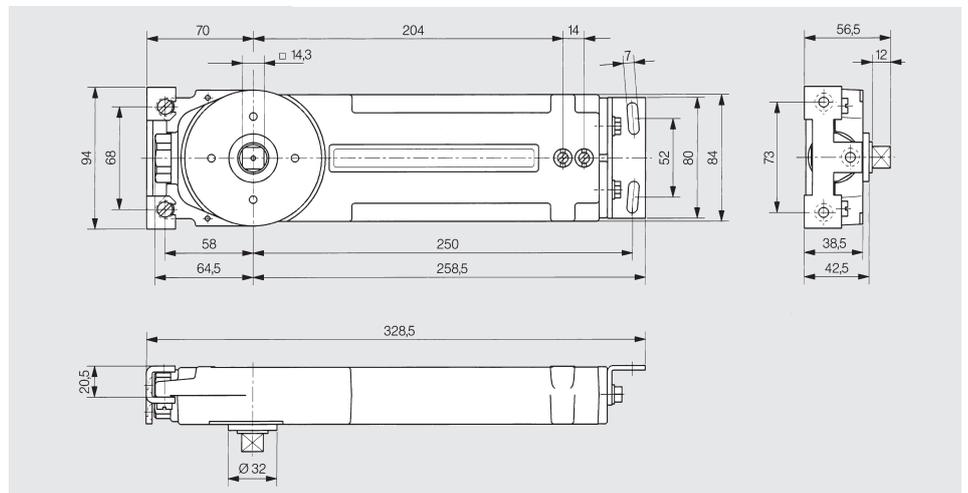
\* Angle d'ouverture de la porte, max. 130° des deux côtés ; dans le cas de portes lourdes qui peuvent être ouvertes davantage, il est indispensable d'utiliser des butoirs de porte. Avec les portes à butée, l'angle d'ouverture de la porte peut être réduit en fonction de la construction de la porte.
