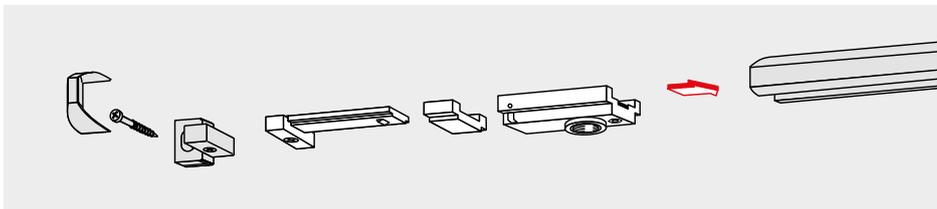
L'arrêt mécanique permet le blocage de la porte (interdit sur portes coupe-feu) à un angle précis jusqu'à un angle d'ouverture de env. 145°.
