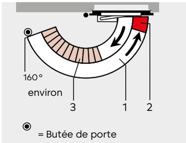
Les réglages hydrauliques sont ajustables en continu par trois vis indépendantes l'une de l'autre.
