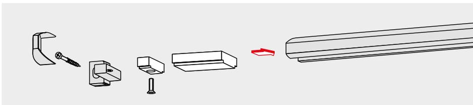
Le limiteur d'ouverture peut être installé dans la glissière ultérieurement. Réglable de 80° à 120° au maximum.
