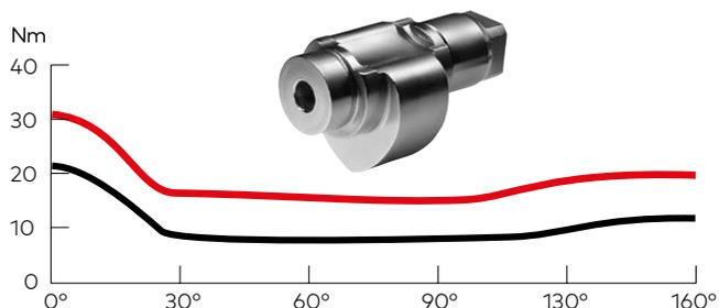
La came symétrique en forme de coeur et l'entraînement linéaire du TS 90 Impulse dormakaba offrent à l'utilisateur un grand confort d'utilisation grâce à une résistance à l'ouverture immédiatement dégressive. Pour les enfants, les personnes âgées et les handicapés, ouvrir la porte est autrement plus facile. Fermeture fiable et contrôlée avec une force de fermeture qui n'augmente que dans la phase finale.
