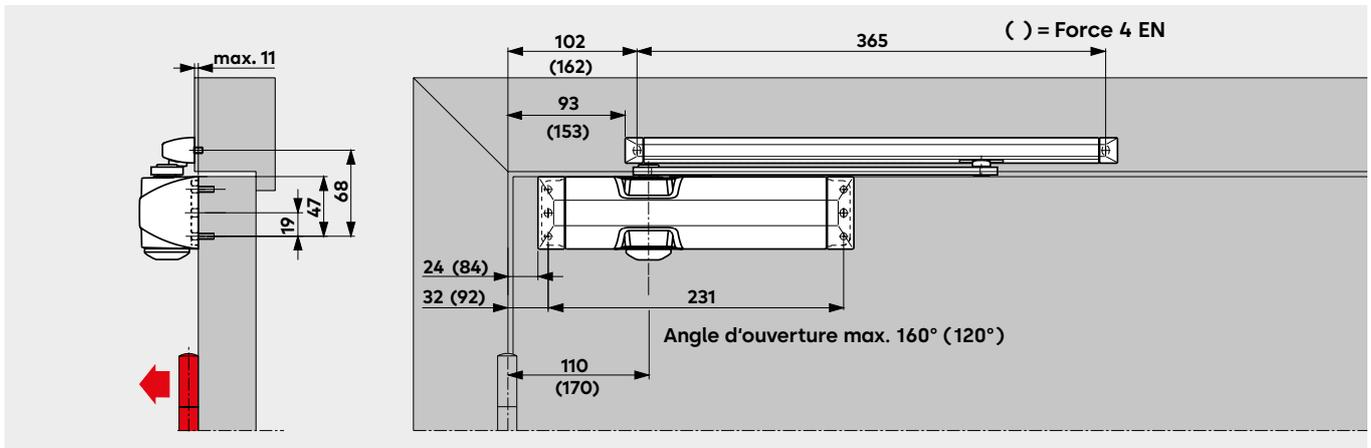
Schéma: exemples sur porte DIN-L. Le schéma serait symétrique sur porte DIN-R.
