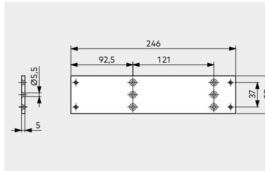
Avec groupe de perçage universel, pour la pose sur profil tubulaire (acier ou aluminium).
