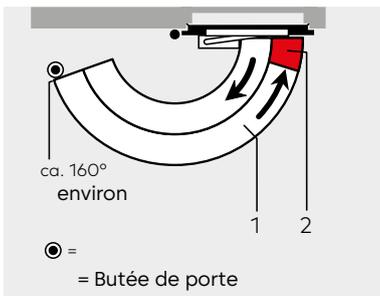
Les réglages hydrauliques sont ajustables en continu par deux vis indépendantes l'une de l'autre.
