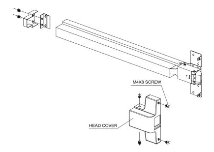
5) INSTALL STRIKE. CHECK THAT DEVICE OPERATES SMOOTHLY AND THAT LATCH BOLT ENGAGES SECURELY. ADJUST STRIKE IF REQUIRED.
