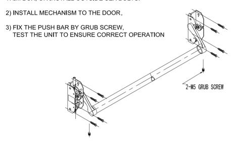
4) INSTALL TOP STRIKE AND BOTTOM STRIKES, AND THEN INSTALL PULLMAN LATCH BODIES TO ENSURE THAT THE LATCHBOLTS ENGAGE SECURELY TO THE STRIKE.
