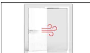
**Freinage à l'ouverture (de 60 à 90°) de série :** absorption de l'élan de la porte en cas d'ouverture de, brutale ou d'entraînement par le vent. Protège le mur et la porte. Il est toutefois recommandé d'installer une butée de porte.
