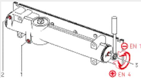
El tiempo de cierre del TS 92 XEA se puede ajustar de forma continua utilizando válvulas (1 + 2) en dos zonas independientes. Con el TS 92 XEA, el ajuste de la fuerza de cierre para el respectivo ancho de puerta puede realizarse de forma continua mediante el tornillo de ajuste lateral (3).
