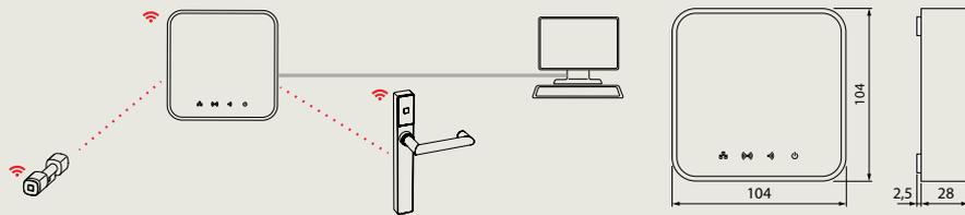
Il wireless gateway 90 40 è connesso via radio ai componenti di controllo porta e via cavo Ethernet con il sistema di controllo accessi.
