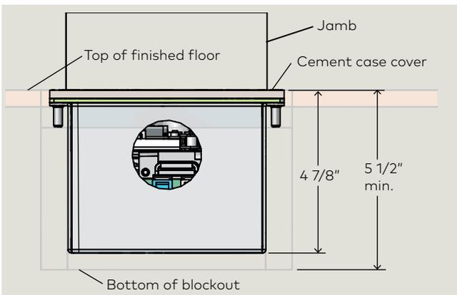
Fig. 16.2.2 End view, door pivot side (offset pivot door)
