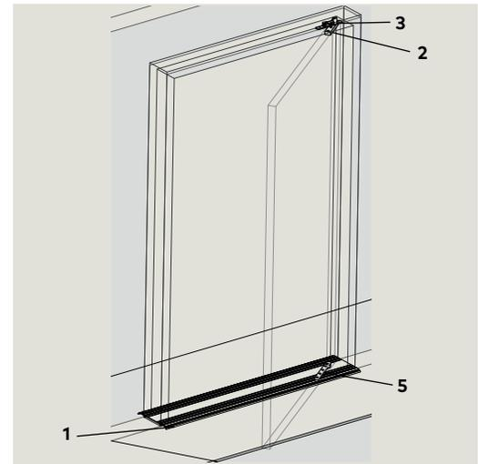
Fig. 16.18.3 LH slide arm and track door
