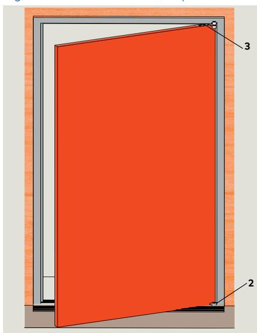
Fig. 4.1.2.1 Offset pivot arm and top pivot
