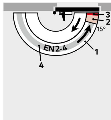
La **velocità di chiusura** nel TS 72 è regolabile in modo continuo tramite valvole in due intervalli reciprocamente indipendenti. Inoltre, il **finecorsa** può essere regolato tramite la tiranteria del chiudiporta.
