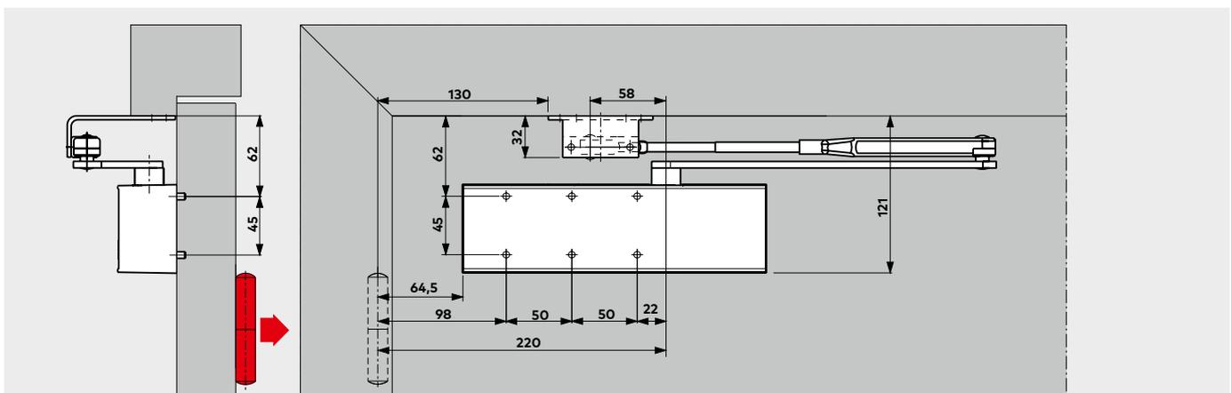
Esempio: Porta DIN a destra, porta DIN a sinistra speculare. Necessario angolo braccio parallelo (accessorio)
