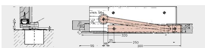
**Max. angolo di apertura, angolo di risposta per l'apertura ammortizzata e angolo di bloccaggio**
