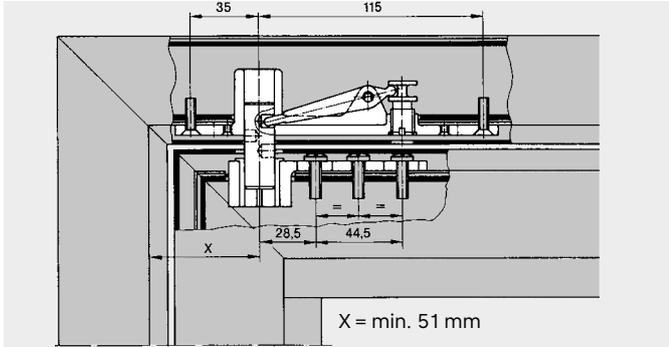
**Per porte in acciaio** Cerniera a perno 7461
