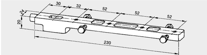
In acciaio, forgiate, zincate e regolabili per i diversi sistemi di profili. N. ordine 46010002
